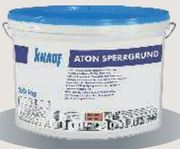
Izolacijski i blokirajući pretpremaz prije nanošenja završnih mineralnih i pastoznih žbuka, bijelo pigmentiran. Za unutarnju i vanjsku primjenu na gipsanim i gips-vlaknastim pločama, disperzijskim bojama, mineralnim podlogama. Sprječava izbijanje lignina i žutila iz podloge. Utrošak: oko 200-250 g/m<sup>2</sup> po nanosu
