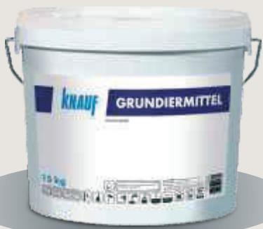
Za podlove s različitom i jakom upojnošću. Primjenjuje se u unutarnjim prostorima kao temeljni premaz na jako upijajućim podlogama, kao što su npr. plinobeton ili opeka i sl. Knauf Grundiermittel nanosi se prije žbukanja kako bi se smanjila opasnost od izgaranja žbuke i prije lijepljenja Knauf ploča s Perlfix ljepilom na zidove, kako bi se poboljšala prionjivost ljepila na podlozi.
