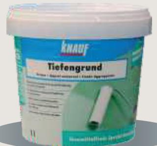
Dubinski predpremaz za upijajuće podloge: gipsane, vagnene i vapno-cementne žbuke, suhi estrih, gipsane i gips-vlaknaste ploče, cementni estrih i estrih iz kalcij-sulfata, itd. Služi za izjednačavanje upojnosti podloge prije lijepljenja keramike, bojanja/ ličenja, gletanja, nanošenja niveler masa, itd. Za unutarnju i vanjsku primjenu. Utrošak: cca. 100 ml/m<sup>2</sup>.
