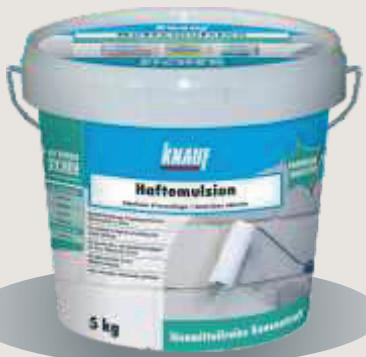
Specijalni temeljni premaz za jako upijajuće podloge: opeka, vagnenac, plinobeton/porobeton, itd. prije gletanja i žbukanja, sredstvo za oplemenjivanje vapneno-cementnih žbuka, betona, cementnih estriha radi poboljšanja prionjivosti, kao vezivni premaz za keramičke pločice i kamene ploče. Za unutarnju i vanjsku primjenu. Utrošak: cca. 100 g/m<sup>2</sup> ovisno o upojnosti podloge.
