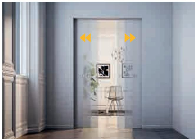
Uporabno za ECLISSE SYNTHESIS® LINE DVOKRILNA and ECLISSE SYNTHESIS® LUCE DVOKRILNA modele, sinhronizacija omogoča istočasno odpiranje in zapiranje obeh kril hkrati, navkljub premikanju samo enega krila. Ta mehanizem poveča funkcionalnost sploh pri večjih širinah vrat.
